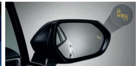
ระบบช่วยเตือนมุมอับสายตาที่กระจกมองข้าง BSM (Blind Spot Monitor)
